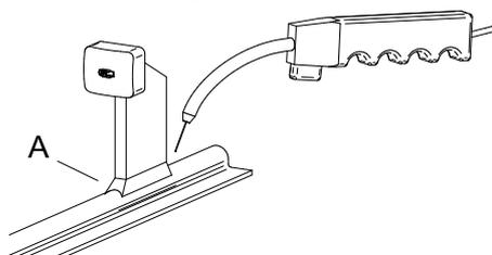
2) Assicurarsi che la zona di saldatura sia pulita e che possa resistere agli urti trasmessi dal battente. Eseguire una saldatura continua su tutto il contorno del battente. Curare in particolare la saldatura nel punto A.
